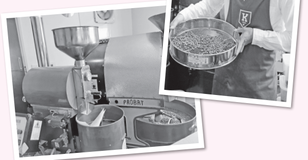
▲コーヒー豆の焙煎機(手前が小型、後方が大型焙煎機)
