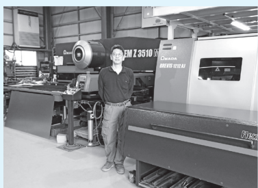
大型工作機械が並ぶ工場。右がファイバーレーザーマシン、左がタレットパンチプレス
